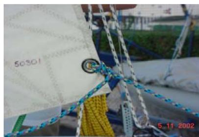
Figura 23 – modo de fijar la escota del foque
