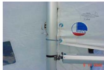
Figura 24 – puño da amura: ejemplo con el cabo cazado
